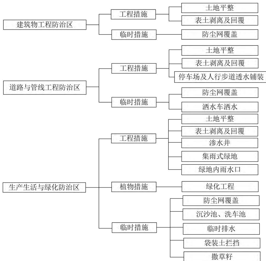
图 3-1 初设水土流失防治措施体系框图
