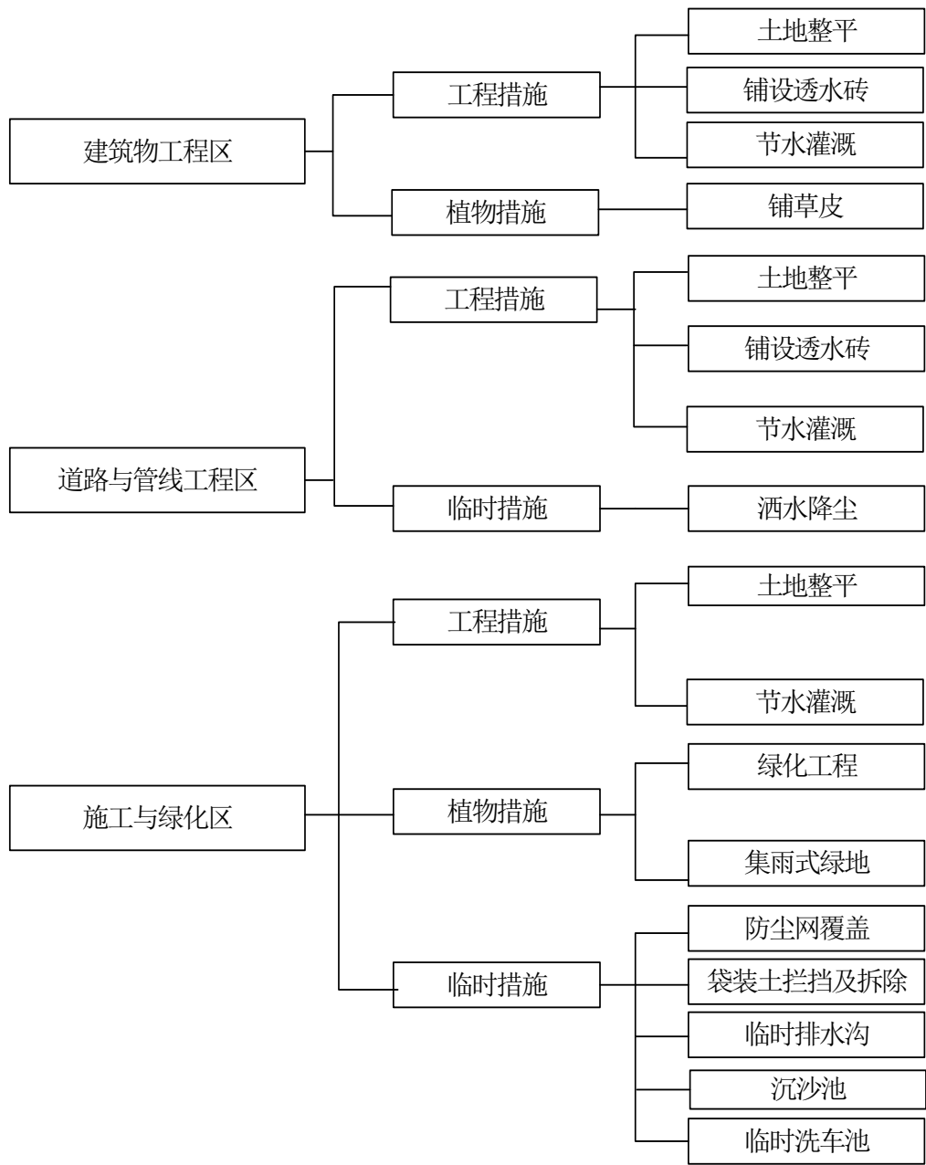
图 3-2 实际水土保持防治措施体系框图
