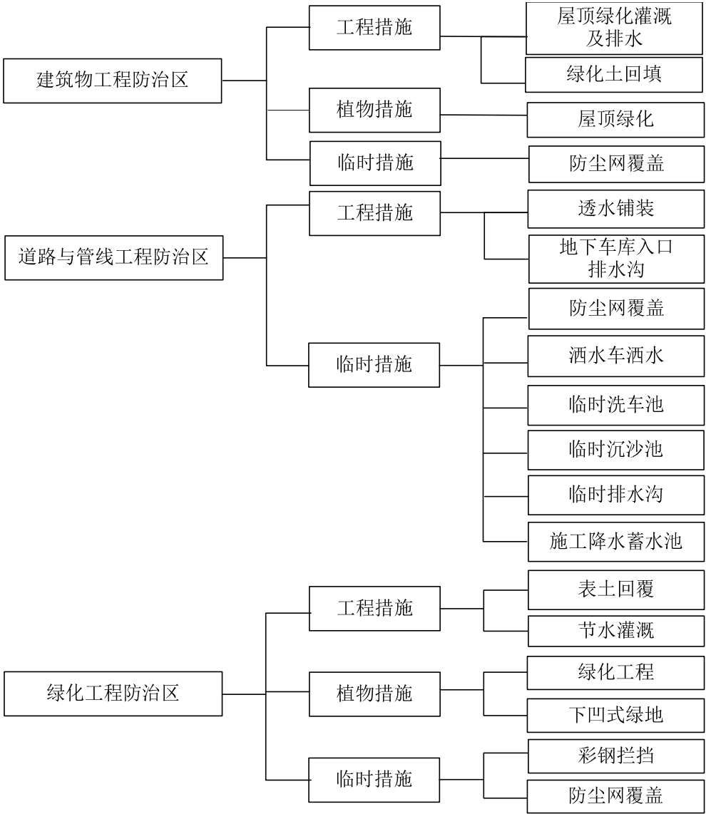
图 3-1 方案水土流失防治措施体系框图
