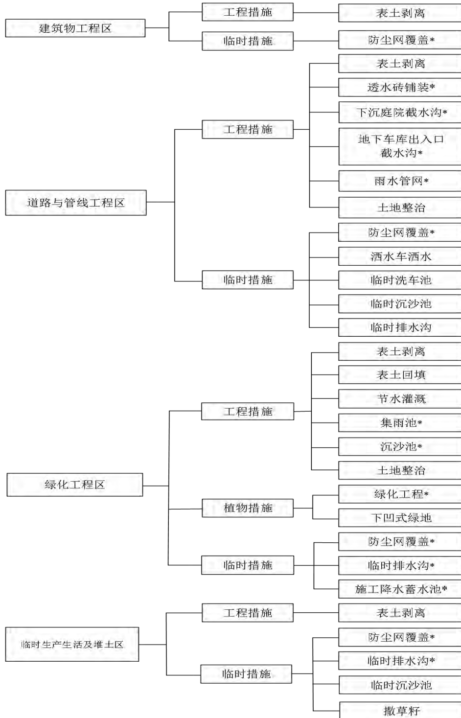
图 3-2 实际实施的水土流失防治措施体系框图
